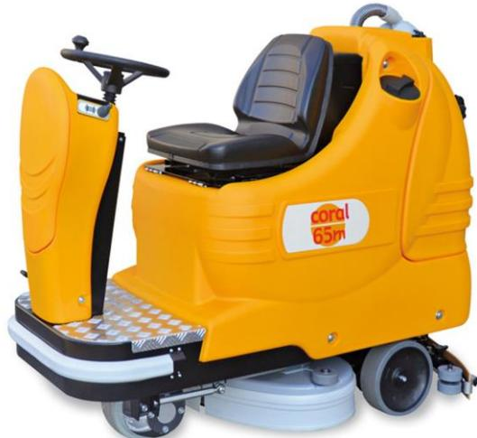
CORAL 65 M II è una lavasciuga con operatore a bordo, alimentata con batterie a 24V ed equipaggiata con un gruppo lavante a due spazzole controrotanti con due riduttori ad ingranaggi con larghezza di lavoro di 65 cm.
